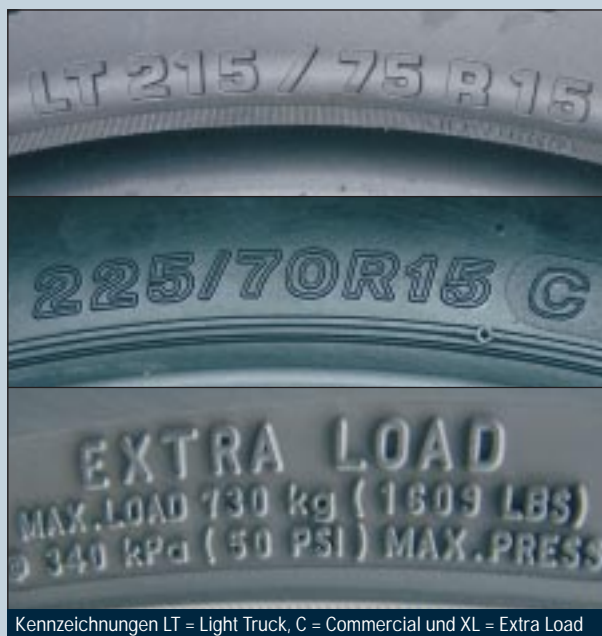
Kennzeichnungen LT = Light Truck, C = Commercial und XL = Extra Load
