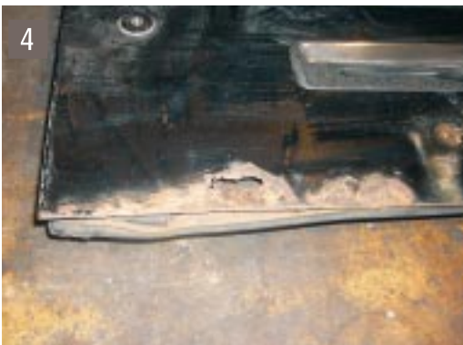
4 Schwachstelle: Rost an Heckklappe und Scharnieren.
