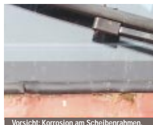
Vorsicht: Korrosion am Scheibenrahmen.
