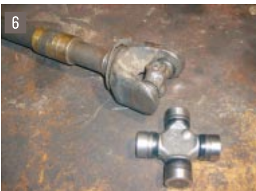
6 Knackpunkt: Schwachstelle sind die Kreuzgelenke der VA.
